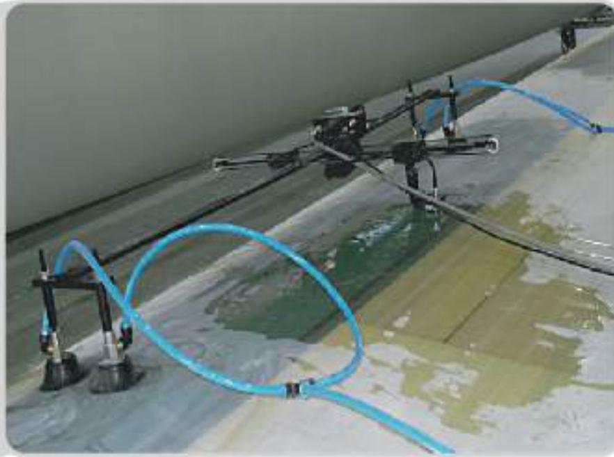
▲ 검사 자동화 시스템 블레이드 부착 모습
